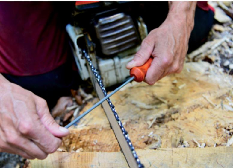
Feinschliff bis ins Detail, je nach Arbeit wird die Sägekette angepasst.
