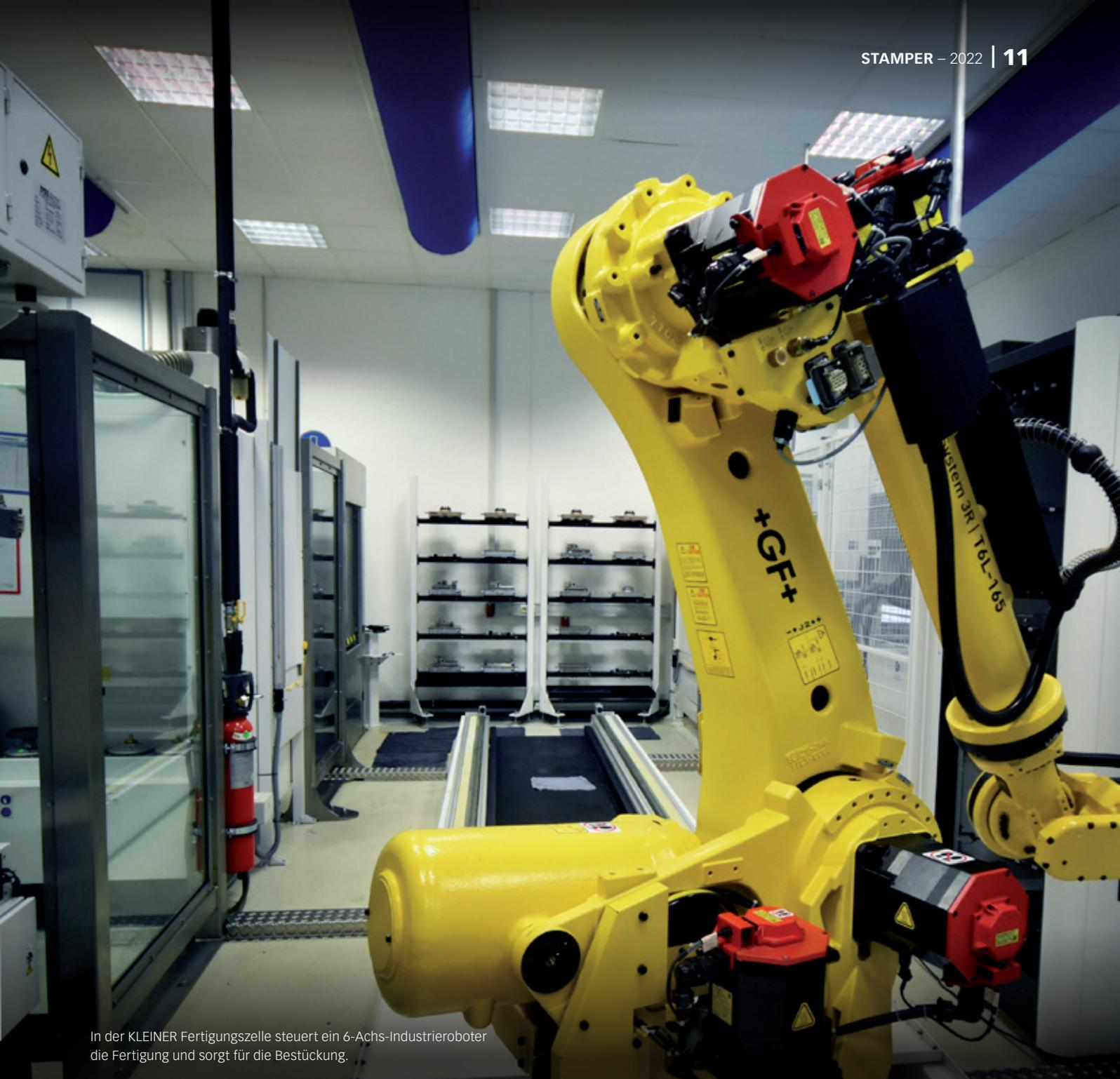
In der KLEINER Fertigungszelle steuert ein 6-Achs-Industrieroboter die Fertigung und sorgt für die Bestückung.
