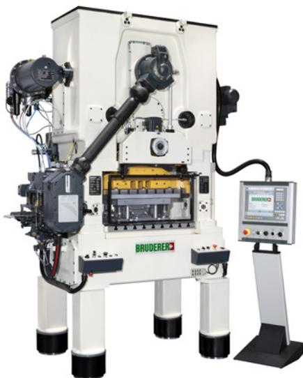
Beispiel eines BRUDERER Retrofit, BSTA 50R-95 mit B2 Steuerung und einem BBV 202/120 Walzenvorschub.
