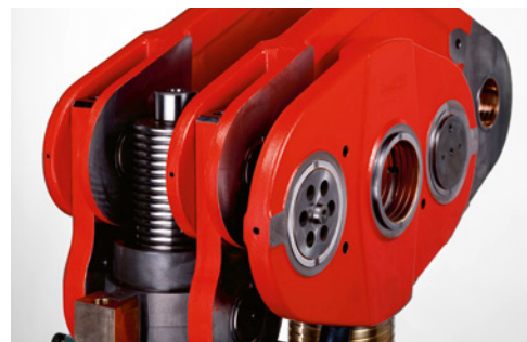
Přestavení beranu během provozu za výrobních podmínek
