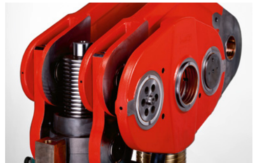
Přestavení beranu během provozu za výrobních podmínek
