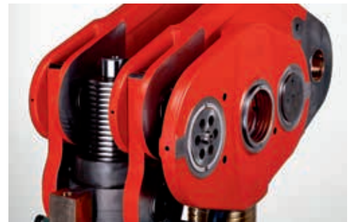
Stösselverstellung während des Laufs unter Produktionsbedingungen.
