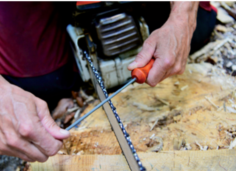
Grâce à un affûtage minutieux, la chaîne est préparée spécifiquement pour la tâche prévue.
