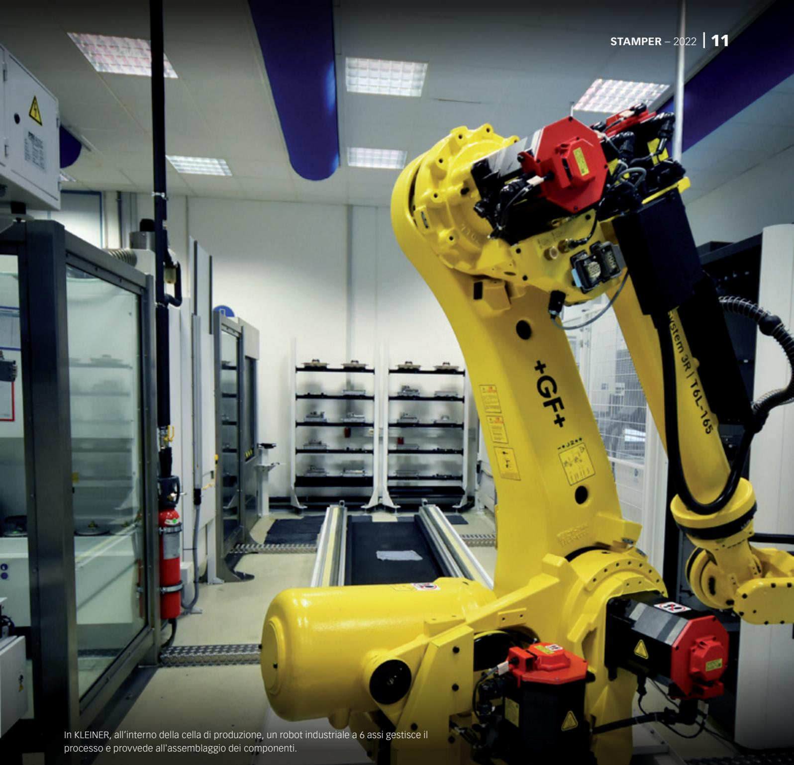
In KLEINER, all'interno della cella di produzione, un robot industriale a 6 assi gestisce il processo e provvede all'assemblaggio dei componenti.
