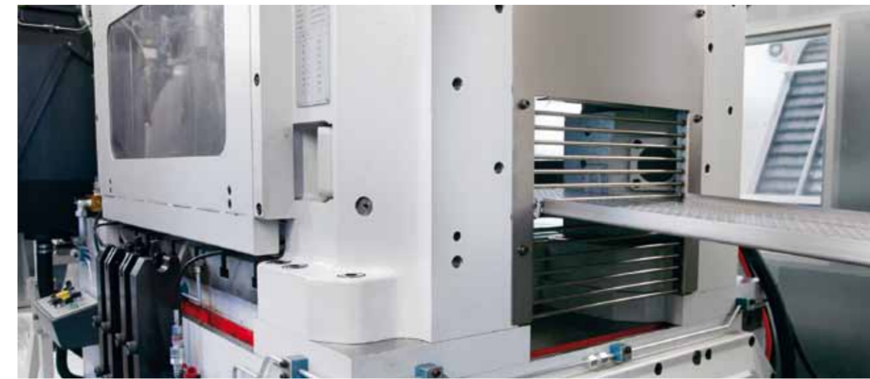
Das nach dem Stanzprozess verbleibende Band wird mittels ARKU-Aufwickler dem Haspel zugeführt.
