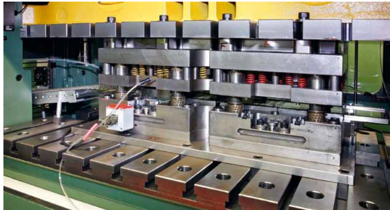
Die zwei nacheinander angeordneten Werkzeugsätze (rechts zum Stanzen, links zum Umformen) ermöglichen die Herstellung von Erdungsbändern im Dauerbetrieb.
