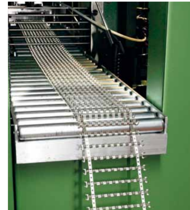
Die verzinneten Kupfererdungsbänder wurden bisher auf kleineren Maschinen hergestellt.
