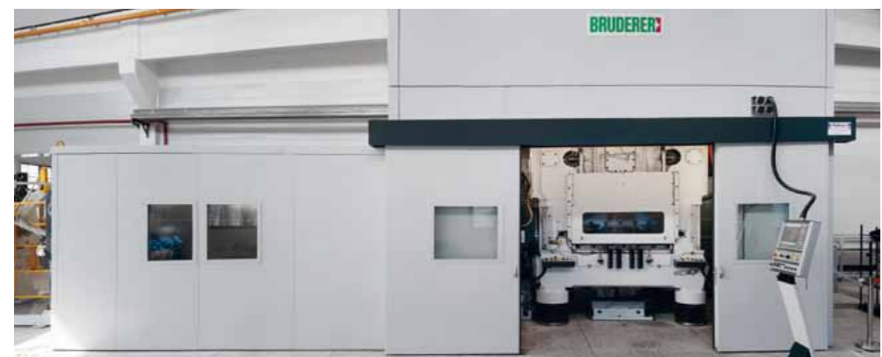
Der BSTA 1600-117 produziert hinter den Türen der Schallschutzkabine mit höchster Präzision und Effizienz Münzrohlinge.
