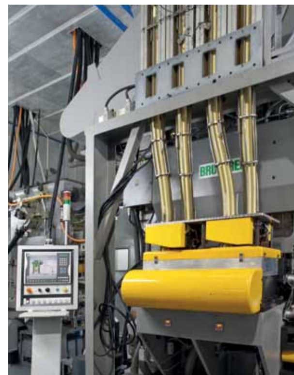
Gli shell impilati sono alimentati alla BSTA 1250-117 dove avviene l'applicazione della linguetta.
