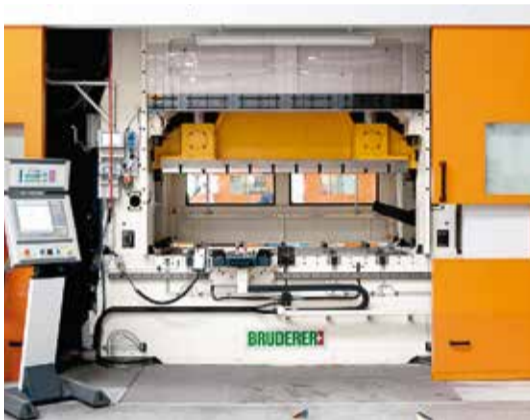
Tanto spazio per gli stampi lunghi: la BSTA 2500 ha un piano da 2700 mm.
