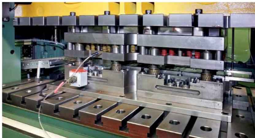
Les deux outils montés en ligne (à dr. pour le découpage et à g. pour l'estampage) permettent de produire des bandes de connexion de masses, en bobine, en une seule opération continue.
