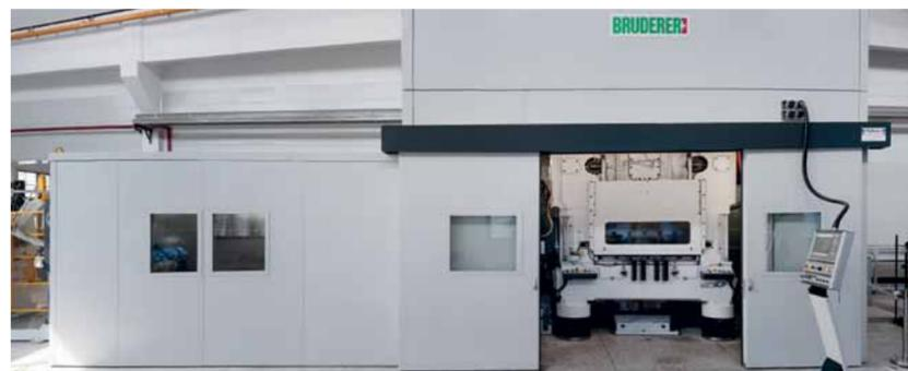
A l'abri des portes de la cabine insonorisée, la BSTA 1600-117 fabrique des flans d'une précision constante.
