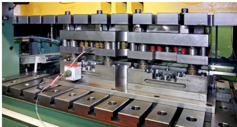
I due stampi montati in linea (trancitura a destra, formatura a sinistra) consentono di produrre in continuo le piastrelle di messa a terra.
